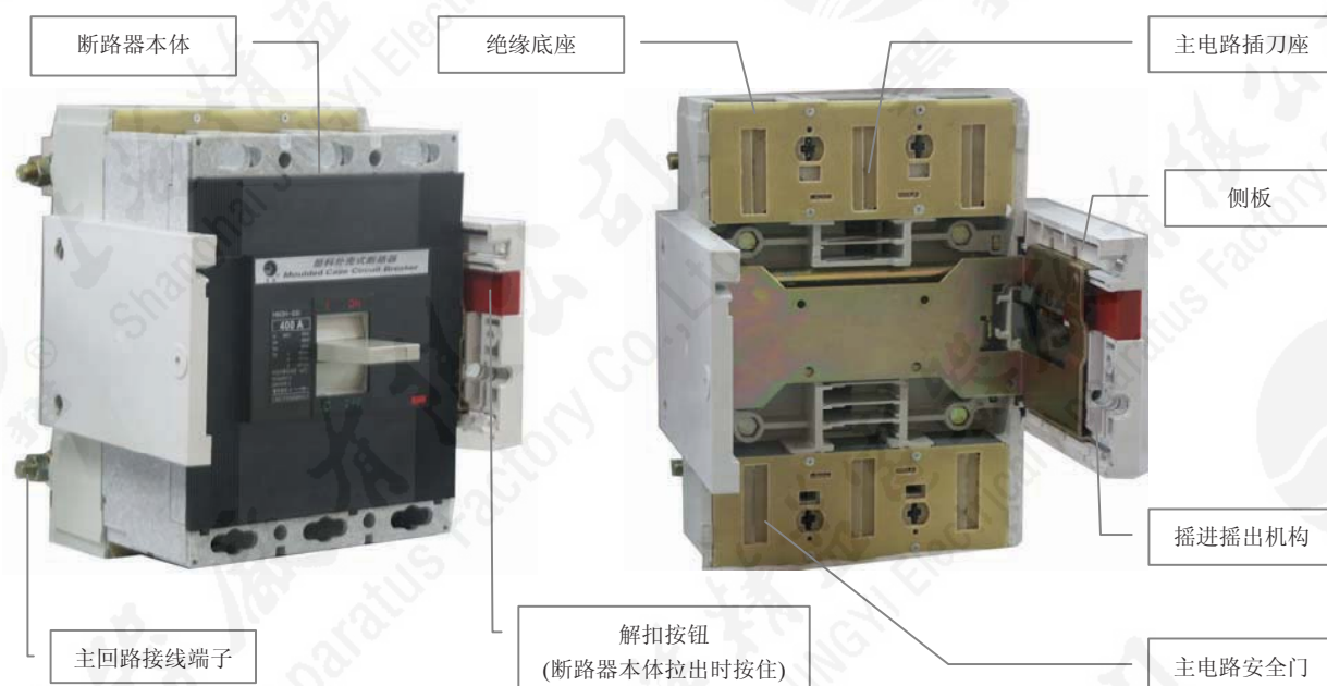
图 1-11 抽出式断路器结构
