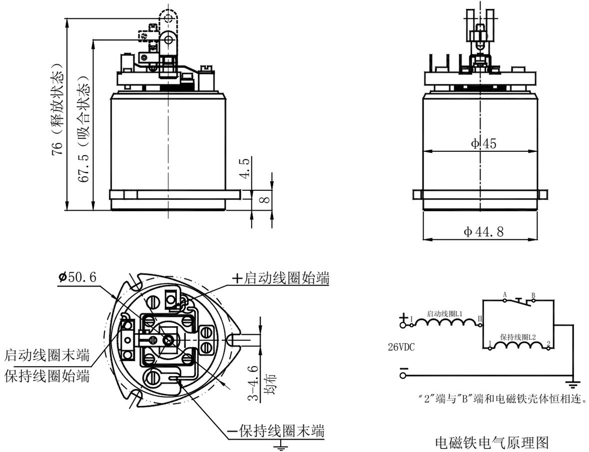
电磁铁电气原理图
